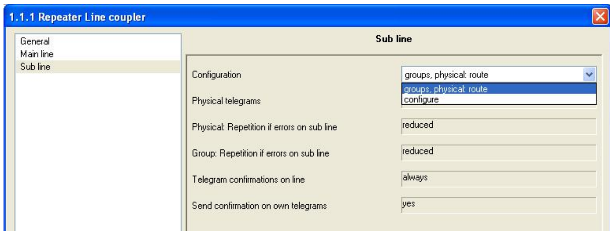
Fig.4.6: parameter window “Sub line”
